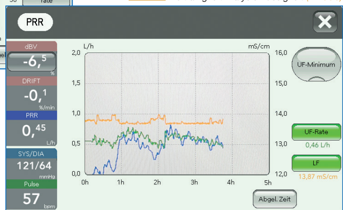
Verlaufskurven der Plasma Refilling Rate (PRR), der UF-Rate (BV-UFC) und der Leitfähigkeit der Dialysierflüssigkeit (BV-COC)
